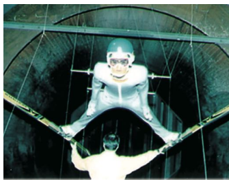
スキージャンプの人形を用いて行ったV字姿勢の実験風景(IOCスポーツ科学教育プログラムより)
