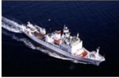
総トン数 2,630トン 国際トン数 2,842トン 長さ83.01m、幅15.00m、 深さ 6.80m、速力17.00ノット 定員65(船員47、調査員11、他7) 船籍港 東京 1881年(H3)年7月31 日建造
