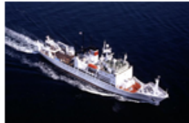
総トン数 2,630トン 国際トン数 2,042トン 長さ33.01m、幅15.00m、 深さ 6.80m、速力17.00ノット 定員65(船員47、調査員11、他7) 船籍地 東京 1981年(H3)年7月31 日建造
