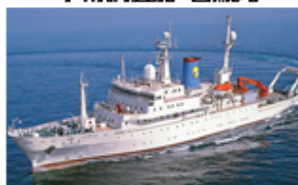
総トン数 トン3,887 国際トン数 3,881トン 長さ100.00m、幅16.2m 深さ 8.8m、速力 16.00ノット 定員88(乗組員54、研究者等35) 船籍地 東京 1988年(H元)年8月28日竣工(三菱重工・下関)
